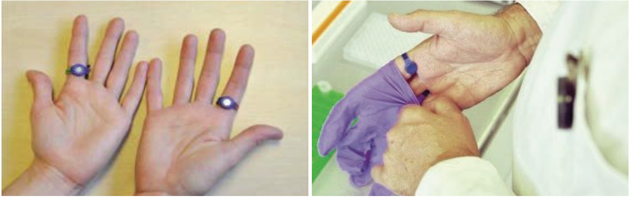
Figuur 2. Links: plaatsing vingerdosimeters. Rechts: handschoenen dragen over de vingerdosimeters.
